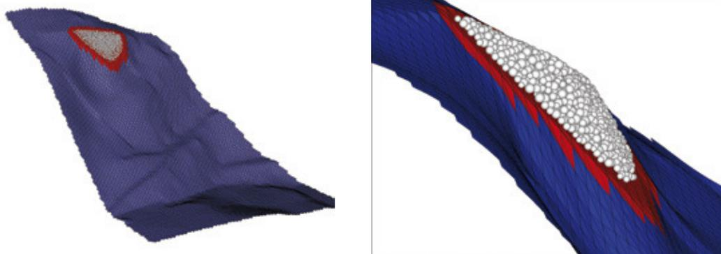
Abb. 9: Modellierung eines Felssturzes mit einem Abbruchvolumen von ca. 2600 m<sup>3</sup>; Sturzmasse und Geländeoberfläche (9a), Sturzmasse repräsentiert durch eine irreguläre Partikelanordnung (9b) (Preh, 2010).
